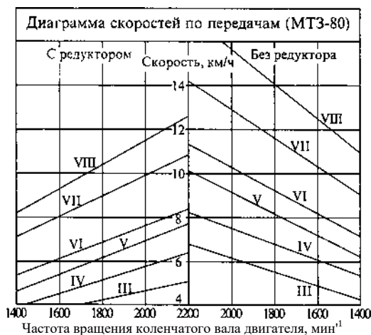
Рис. 74. Диаграмма рабочих скоростей трактора МТЗ-80: III... VIII — рабочие передачи
